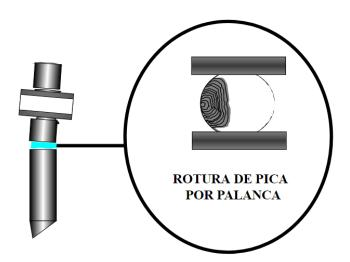
Las líneas de propagación de la ruptura por palanca se identifican de acuerdo con la siguiente ilustración, y de coincidir estas con algún reclamo de garantía, este será denegado. Asegúrese de identificar la causa de ruptura antes de iniciar un reclamo.
